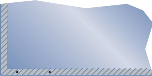
Vitrage isolant : le revêtement agit comme une boucle d'alarme invisible
