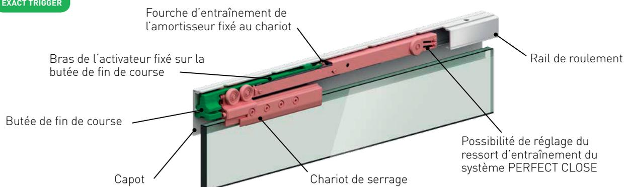
À l'intérieur du système Portavant 150, le principe de construction éprouvé de la gamme Portavant assure un excellent niveau de qualité et de technologie :
